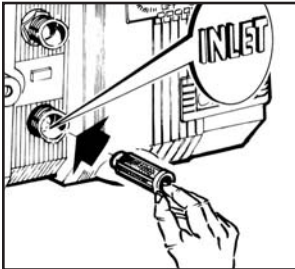
Extraire le filtre du raccord d'arrivée de l'eau.
